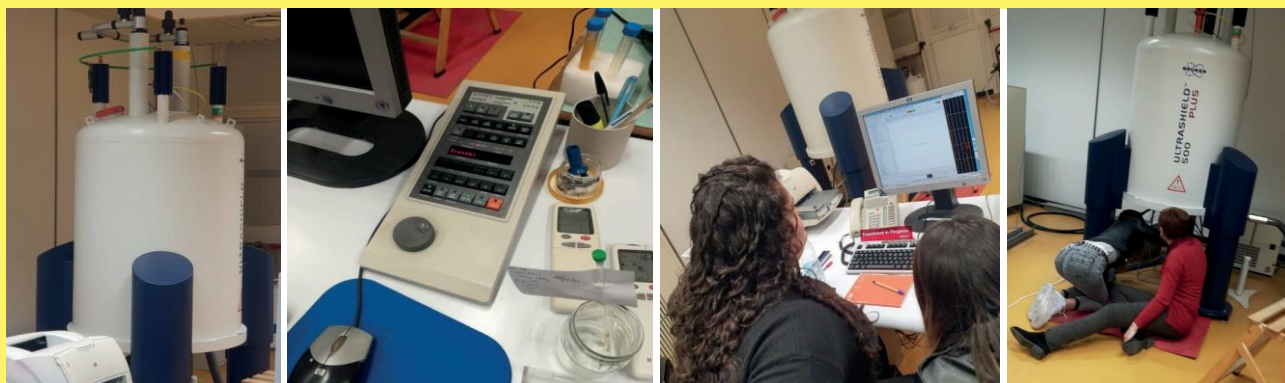
NMR a 500Mhz - Dipartimento di Chimica UniCal e la sua console
